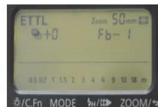
⚠ La fonction de bracketing sera annulée automatiquement au 3<sup>ème</sup> déclenchement.
