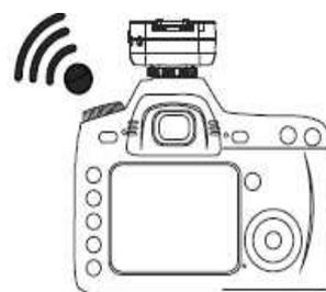
**Mode super synchro :** Utiliser une vitesse de synchro flash non HSS afin d'augmenter la durée de synchro , cette fonction s'applique aux flashes stroboscopiques dont la durée des flashes est supérieure. (Flash connectés sur la prise PC uniquement).
