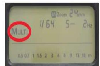
Les 3 paramètres à savoir puissance de flash, fréquence et répétition peuvent se restreindre l'un envers l'autre, le détail des réglages peut se faire via ce mode d'emploi mais aussi avec le mode d'emploi du fabricant du flash. La puissance effective de tous les paramètres se règle sur le menu d'affichage du flash., pour plus de détails veuillez vous reporter à la notice de votre flash.
