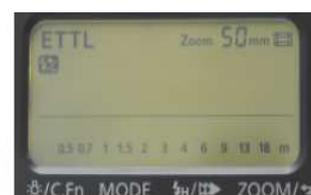
boîtier. Vous pouvez aussi régler chaque valeur FEB (Bracketing) ou FEC (Compensation d'exposition) à travers le menu du boîtier, la valeur de compensation d'exposition sera superposée en fonction du réglage du flash sur le flash lui-même ainsi que sur le menu de réglage du flash sur le boîtier, par exemple le menu du boîtier peut être réglé sur -3, et le flash est réglé sur +3, alors la compensation d'exposition, dans ce cas la compensation d'exposition sera de 0.
